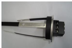
Kondenzatorski konektor je lahko opremljeno z mehansko varovalko, ki zagotavlja trenutno prekinitev notranjih povezav v primeru električnega preboja vgrajenega kondenzatorskega navitja. Na ta način preprečimo neželeno eksplozijo kondenzatorskega ohišja. Vgrajen sistem zagotavlja prekinitev kontaktov pri bombiranju kondenzatorskega pokrova v višino 5mm.
